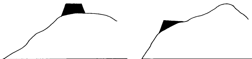
図7 夾築（左）と内托（右）の模式図
